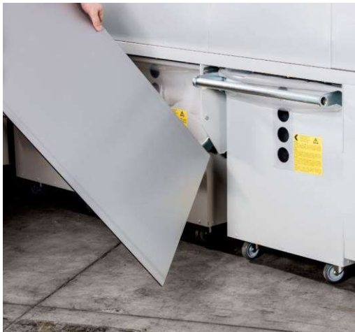
Spänecontainer mit Staubschott
